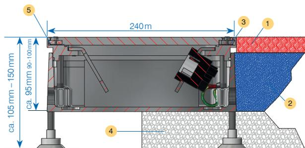
I piedi di livellamento servono ad adattare la presa a pavimento. Classe di carico / stabilità si ottengono solo mediante riempimento posteriore della presa da pavimento con materiale solido (cemento, malta...).
