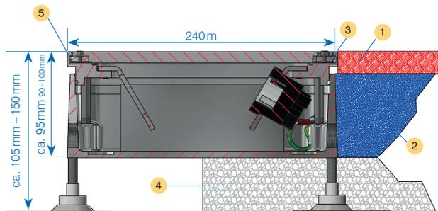
I piedi di livellamento servono ad adattare la presa a pavimento. Classe di carico / stabilità si ottengono solo mediante riempimento posteriore della presa da pavimento con materiale solido (cemento, malta...).
